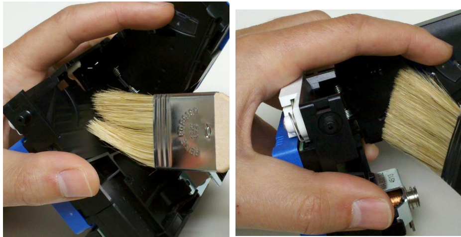
Bild 2: Reinigung des Münzlaufs des EMP 800 v7 mit einem Pinsel
