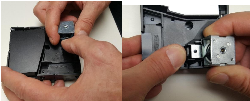
Bild 6 Demontage des Magneten vom EMP 800 v7 und 800 v6
