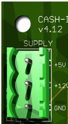
Die Stromversorgung wird an Klemme X1 angeschlossen.
