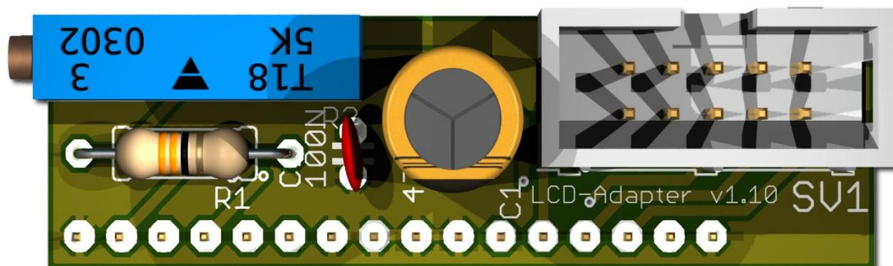
Abhängig vom verwendeten LCD-Display muss der Adapter auf der linken oder rechten Seite montiert werden. Manche Displays haben die Stromversorgung auf der linken Seite, andere auf der rechten Seite! Hinweis: ab Version 1.10 hat der Adapter nur noch 16 Pins.
