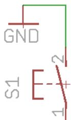
Wir benötigen GROUND an jedem Pin, d.h. die Taster einfach mit GROUND verkabeln!
